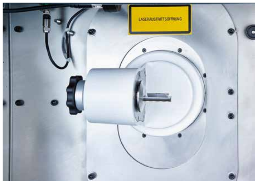
1 Blick in den Innenraum der Lasermaschine Neo von Agathon. Mit ihren sechs Achsen und einem nutzbaren Arbeitsvolumen von 5 cm 3 bringt sie PKD-Rohplatten bis auf zwei bis drei Hundertstel Millimeter an ihre Endkontur; danach wird geschliffen (© Agathon)
